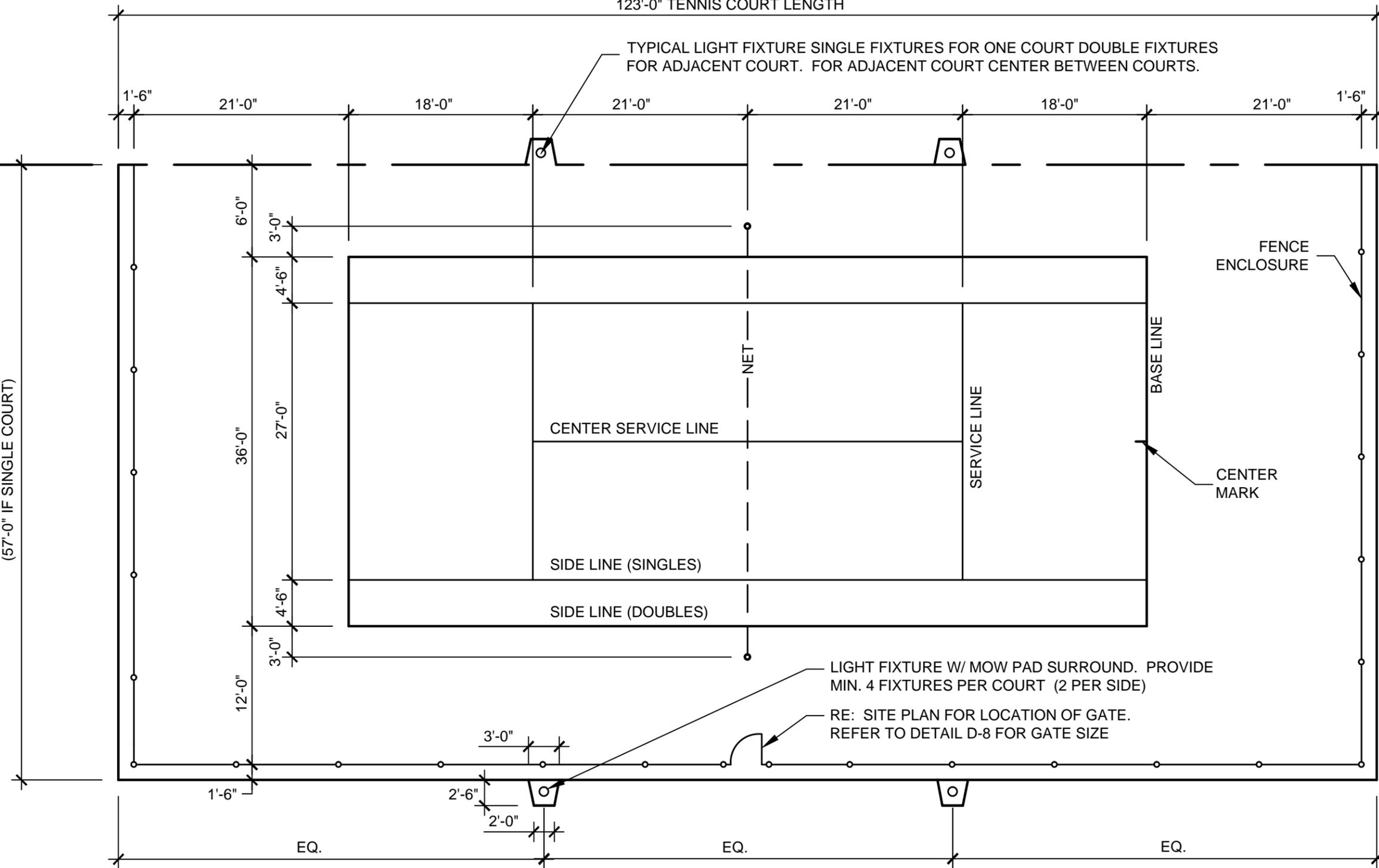
LIGHT FIXTURE W/ MOW PAD SURROUND. PROVIDE MIN. 4 FIXTURES PER COURT (2 PER SIDE)
